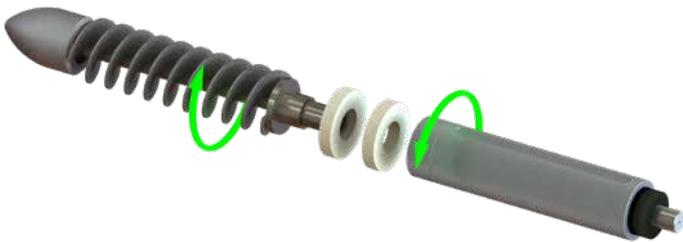
Se recomienda aplicar un poco de Loctite 243 o equivalente a las roscas al volver a montarlas; **apriételas solo a mano.**
