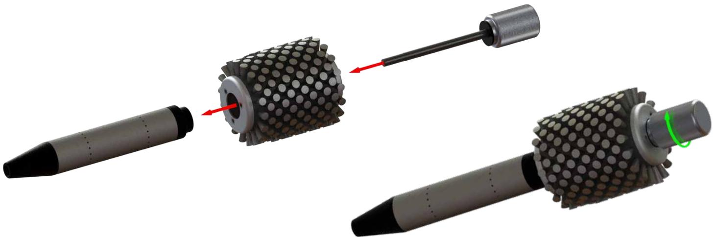
HAY DOS DIÁMETROS EN LA MAYORÍA DE LOS CEPILLOS, EL EXTREMO MÁS PEQUEÑO DEBE ESTAR JUNTO AL FURRET. NO UTILICE PALANCAS DE MANO (11) PARA APRETAR EL CABEZAL DEL CEPILLO AL FERRET, YA QUE LO APRETARÍA DEMASIADO. LAS PALANCAS DE MANO SOLO DEBEN UTILIZARSE SI ES NECESARIO AL DESMONTAR EL CABEZAL.
