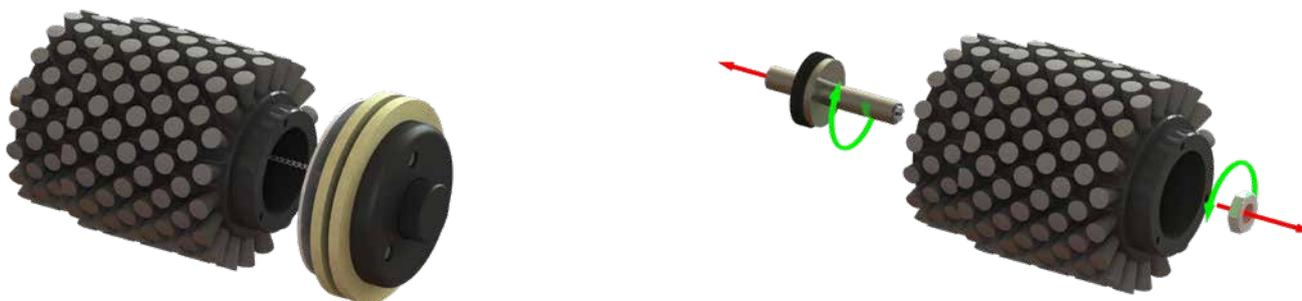
1. Rimuovere le tre viti a testa cilindrica M6 dalla calotta terminale e rimuovere il gruppo completo della calotta terminale, i feltri e il disco di supporto.
