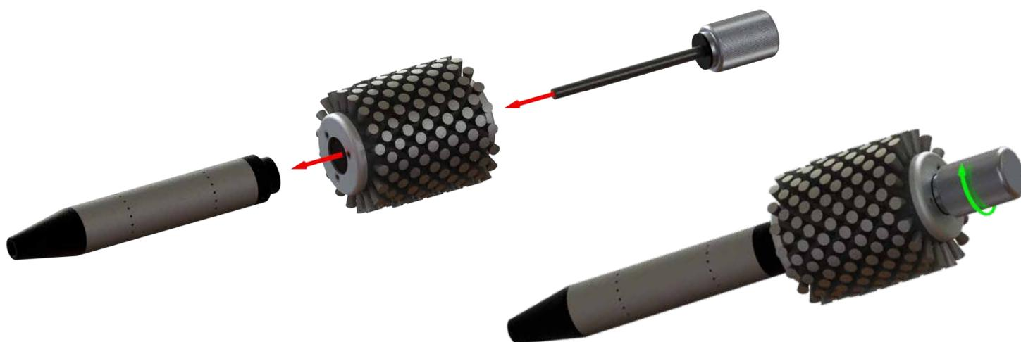
LA MAGGIOR PARTE DELLE SPAZZOLE HA DUE DIAMETRI, L'ESTREMITÀ PIÙ PICCOLA DEVE ESSERE VICINO AL FERRET. NON UTILIZZARE IL PALANCHINO (11) PER STRINGERE LA TESTINA DELLA SPAZZOLA SUL FERRET, IN QUANTO SI RISCHIA DI SERRARLA ECCESSIVAMENTE. I PALANCHINI DEVONO ESSERE UTILIZZATI SOLO SE NECESSARIO PER RIMUOVERE LA TESTINA.
