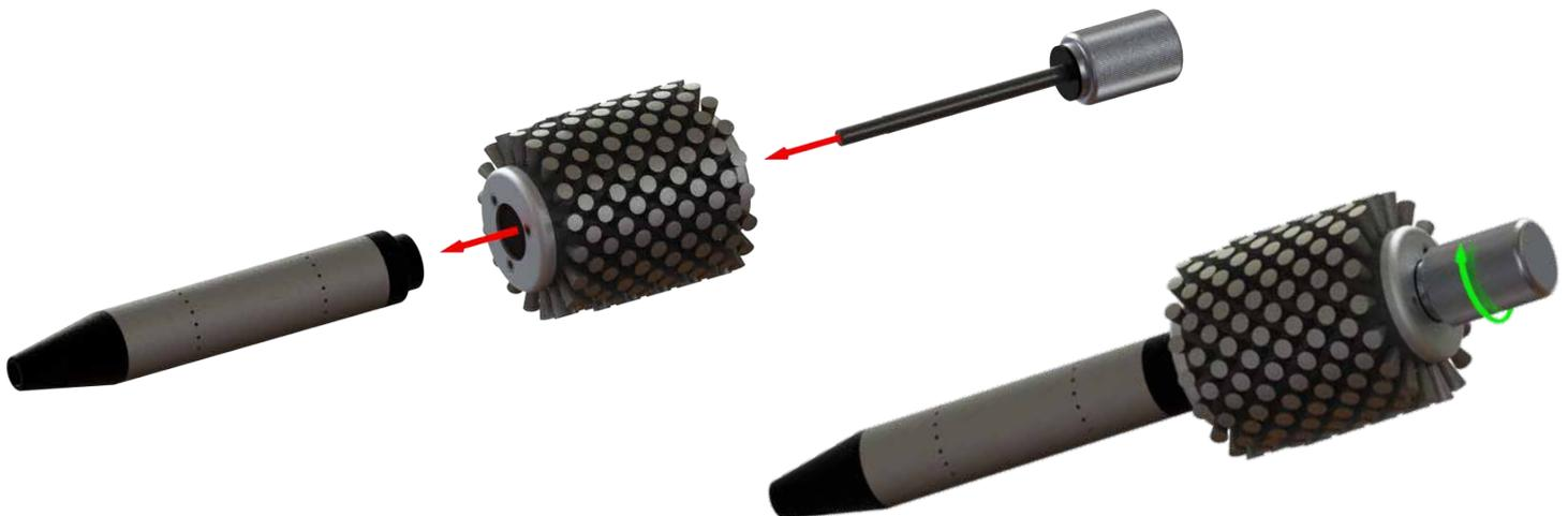
DIE MEISTEN BÜRSTEN HABEN ZWEI DURCHMESSER, DAS KLEINERE ENDE SOLLTE SICH IN DER NÄHE DES FERRET BEFINDEN. BENUTZEN SIE NICHT DEN DREHSTAB (11), UM DEN BÜRSTENKOPF AM FERRET ZU BEFESTIGEN, DA ER SONST ÜBERDREHT WIRD. DER DREHSTAB DARF NUR VERWENDET WERDEN WENN DIES BEIM ABNEHMEN DES KOPFES ERFORDERLICH IST.
