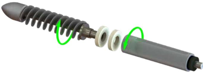
Il est recommandé d'appliquer un peu de Loctite 243 ou équivalent sur les filets lors du réassemblage – **serrez uniquement à la main.**
