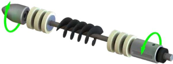
Il est recommandé d'appliquer un peu de Loctite 243 ou équivalent sur les filets lors du réassemblage – serrez uniquement à la main.
