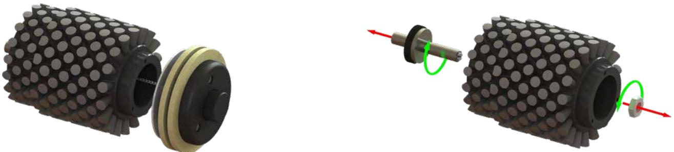
1. Retirez les trois vis à tête cylindrique M6 du capuchon d'extrémité et retirez l'ensemble du capuchon d'extrémité, les feutres et le disque de support.
